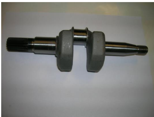
Cigüeñal briggs con espigas de fábrica
